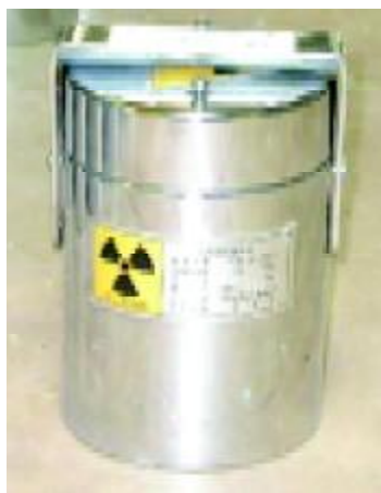
带有电离辐射标志的铯-137放射源包装容器
